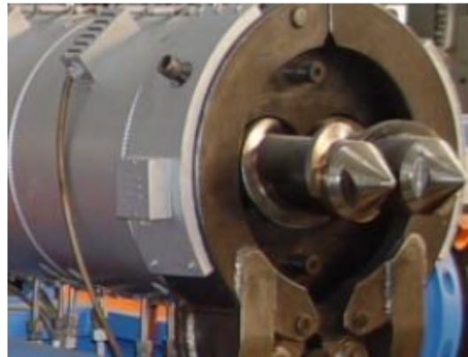
Figure 2.2. Extrudeuse double-vis utilisée au laboratoire de l'Université Washington State
