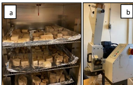
Figure 2.7 : a) Séchage des échantillons dans un four à 50^\circ\text{C} b) Broyeur à couteaux disponible au laboratoire biomatériaux à la Sarre
