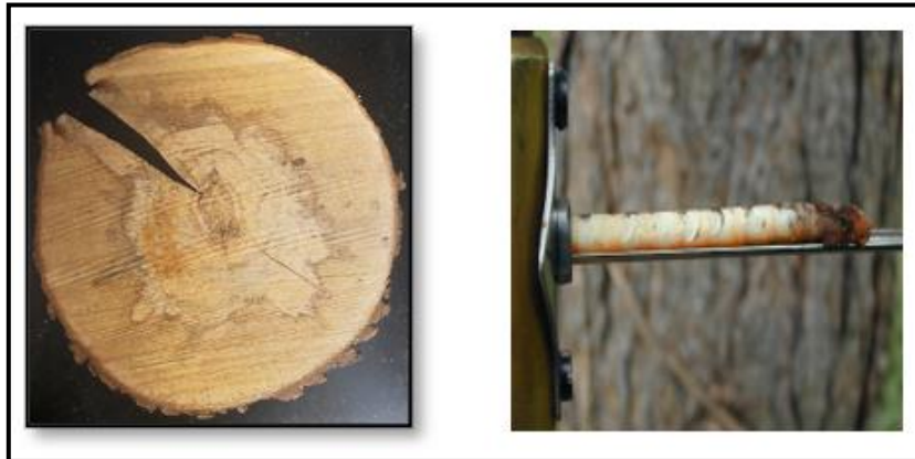
Figure 2.2 : Échantillons de bois : à gauche une rondelle (2 sites, 18 arbres) et à droite une carotte (8 sites, 240 carottes)
