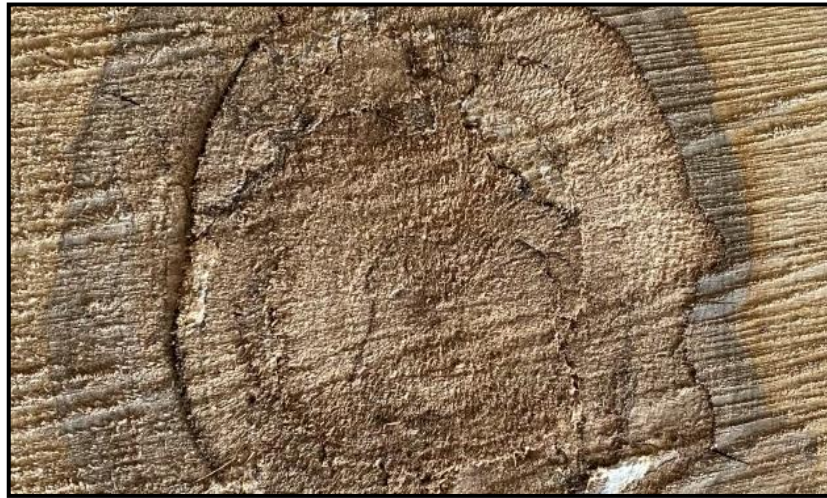
Figure 3.4 : Structure spongieuse du bois d'érable à sucre en phase terminale
