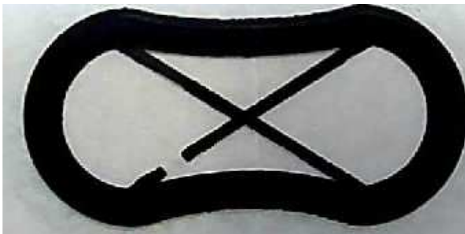
Figure 45 : Image réelle avec défaut
