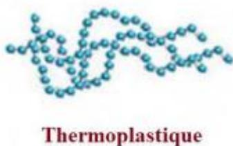
**Figure 2 : Configuration des chaînes de polymères thermoplastique (Ouellette, 2018).**
