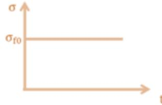
Figure 31 : Essai de fluage représenté par le modèle de Kelvin-Voigt (Liang, 2016)
