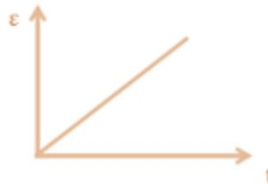
**Figure 27 : Essai de fluage représenté par le modèle de Maxwell (Liang, 2016)**
