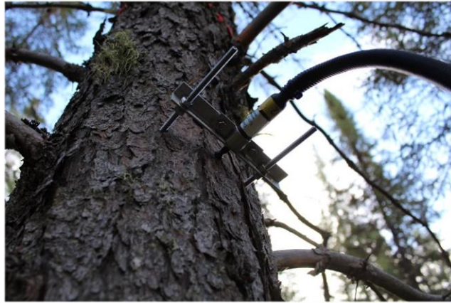
Figure 1.2. Dendromètre à pointe installé sur un pin gris à Amos, en juillet 2022.
