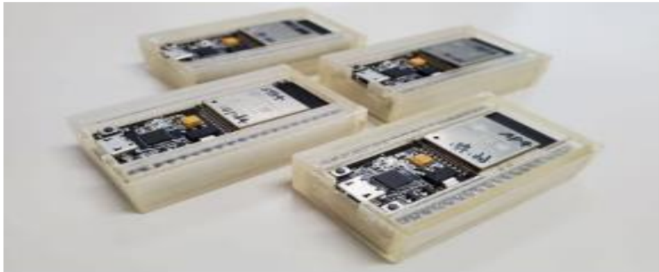
Figure 2: modules ESP32 dans une pièce test
