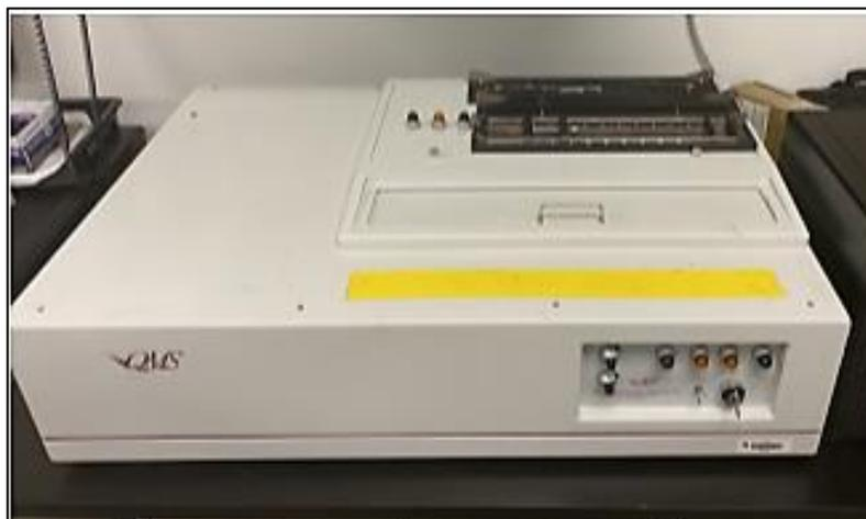
**Figure 2.6** Densitomètre QTRS-OJX Tree Analyser de Quintek Measurement System, Inc.
