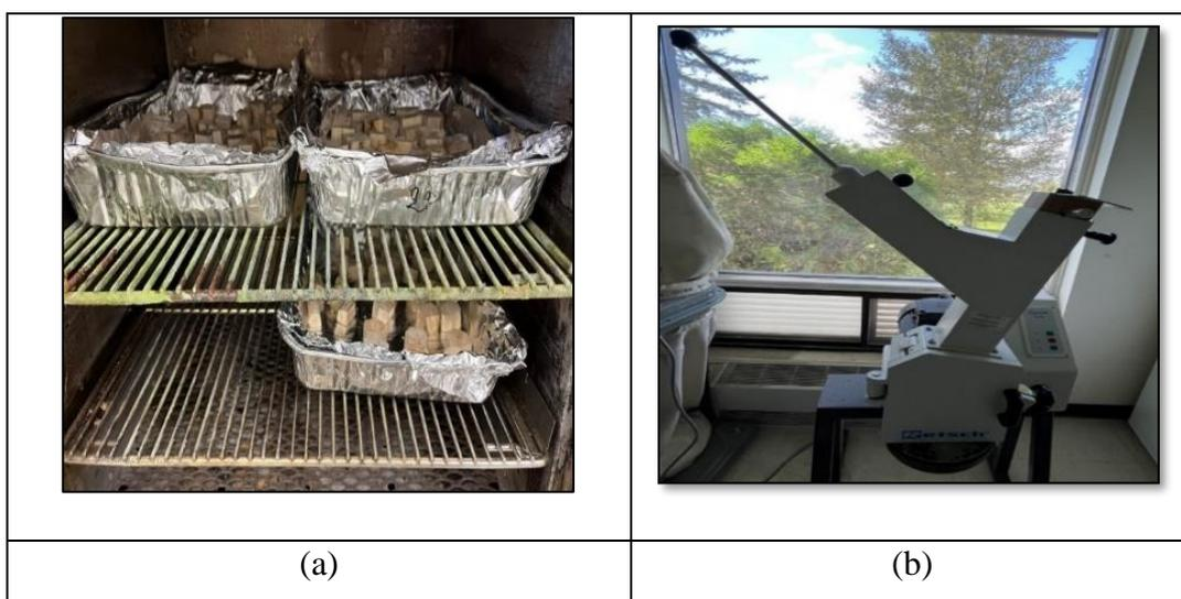
**Figure 2.8** Étapes de la préparation des échantillons : a) Séchage des échantillons dans un four à 50 °C, b) Broyeur à couteaux *Retsch*.
