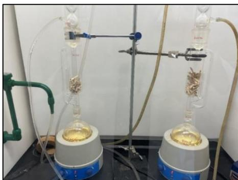
**Figure 2.4** Montage d'extraction Soxhlet pour les carottes.
