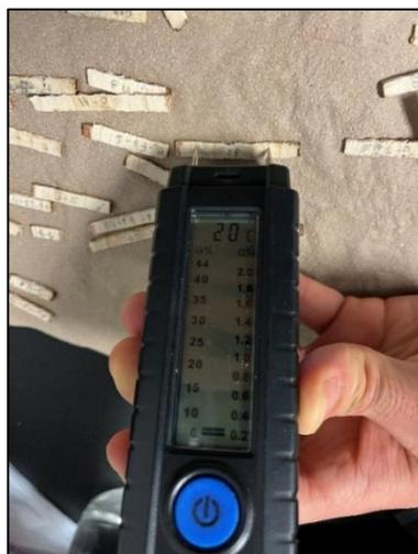
**Figure 2.5** Mesure de la teneur en humidité.
