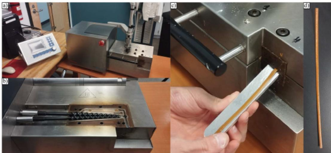
**Figure 3.3 :** Préparation du masterbatch : a) mini-extrudeuse Haake Minilab II, b) système interne de double vis, c) extrusion du masterbatch, d) masterbatch refroidi
