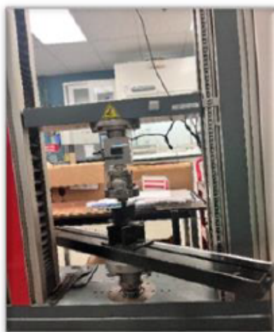
Figure 2.15 Essai de flexion réalisé sur la machine d'essais universelle Zwick
