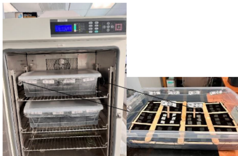
Figure 2.19 Chambre de conditionnement (Labocon LHC-103)
