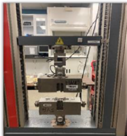
Figure 2.14 Essai de traction réalisé sur la machine d'essais universelle Zwick
