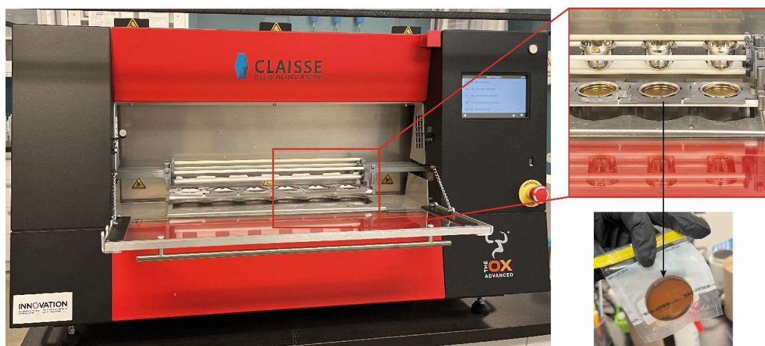
Figure 3-9 Préparation de perles boratées avec le fluxeur CLAISSE TheOx Advanced
