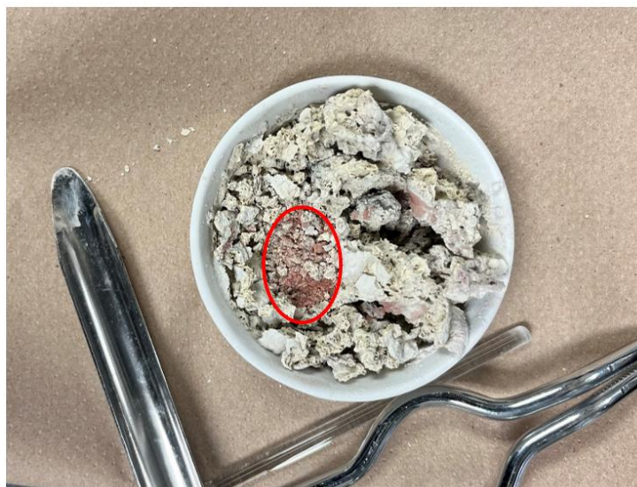
Figure 5-4 Matériau partiellement décomposé obtenu dans l'essai CAS 1 (faible dosage d'acide sulfurique)
