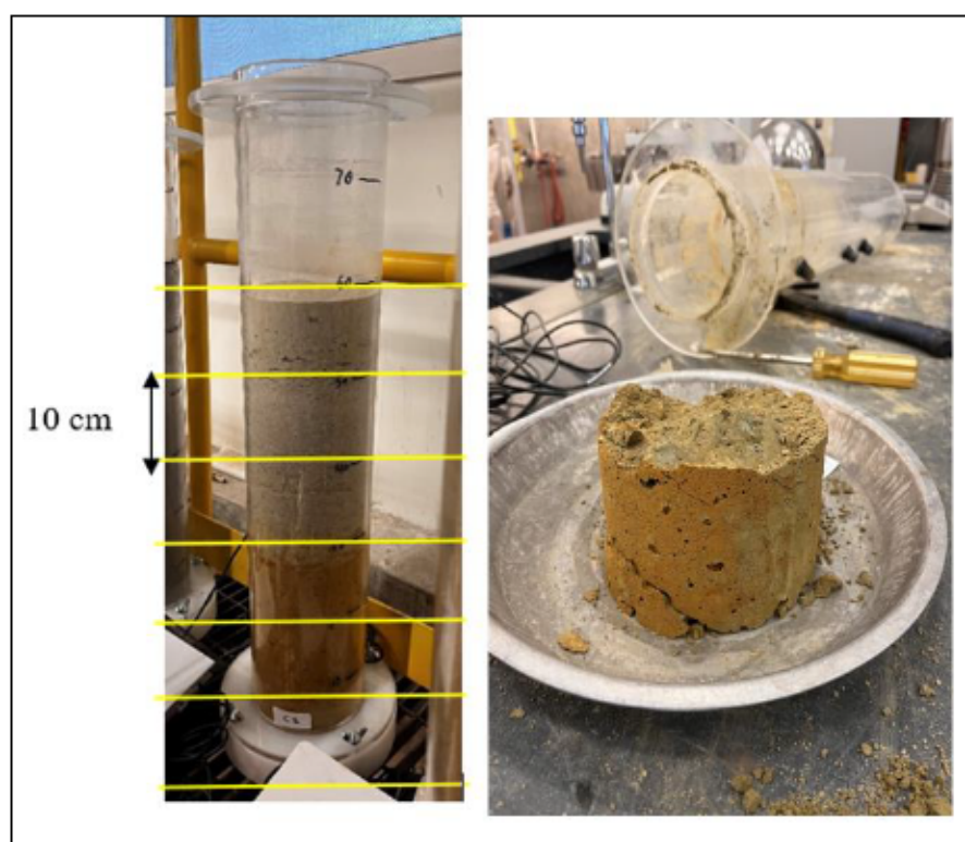
Figure 3.9 Protocole de démantèlement des colonnes
