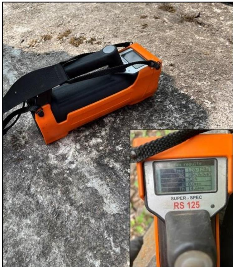
Figure 3.5 : Le spectromètre portatif à rayons gamma portatif, RS-125 Super-SPEC, en position plane de mesure avec un écran qui affiche les paramètres mesurés (K en %), eTh (équivalent Thorium en ppm), eU (équivalent Uranium en ppm), le débit de dose (DR) nShv-1 et le temps de mesure (120s).
