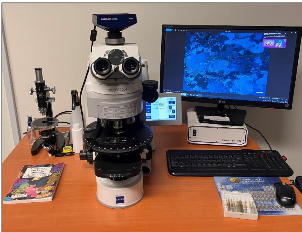
Figure 3.4: Microscope optique « Zeiss Axio Imager », équipé d'une caméra et d'un ordinateur à logiciel de calibration et de visualisation.
