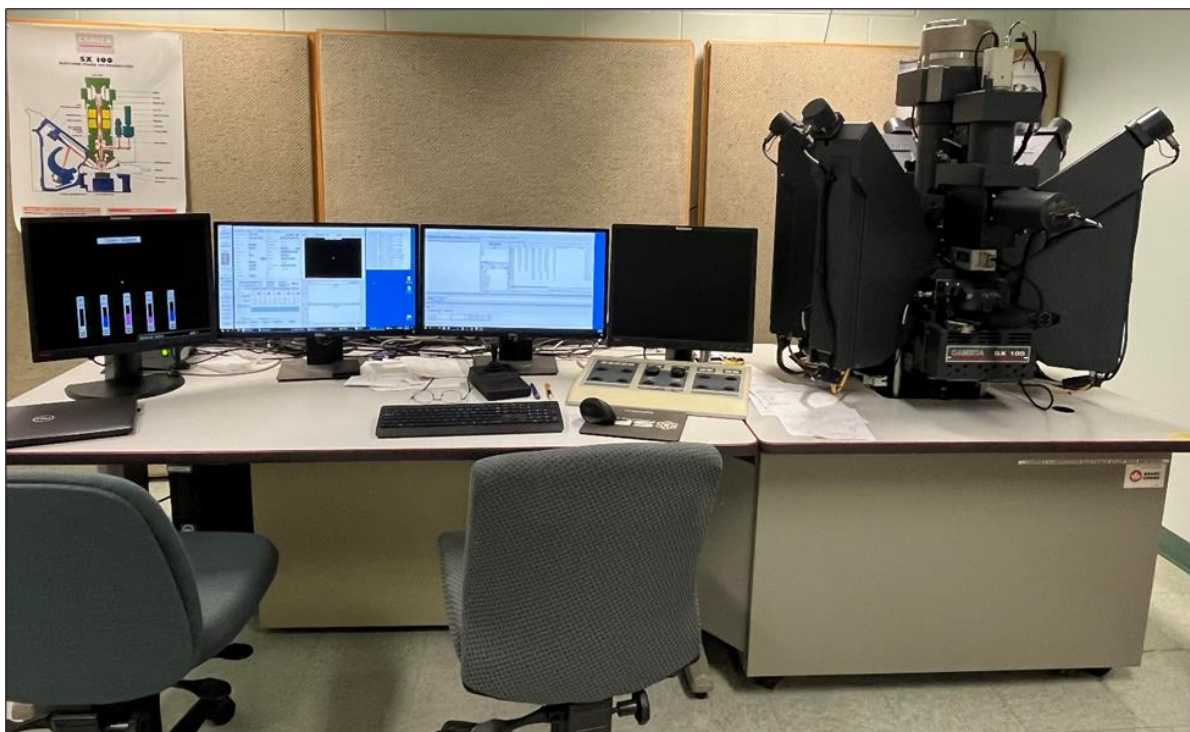
Figure 3.6. Microsonde électronique CAMECA SX-100 pour l'analyse minéralogique au département de géologie et de génie géologique de l'Université Laval.
