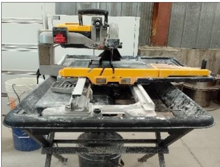
Figure 3.2. Scie fixe pour préparation des échantillons pour les lames minces, les analyses chimiques et le test de coloration.
