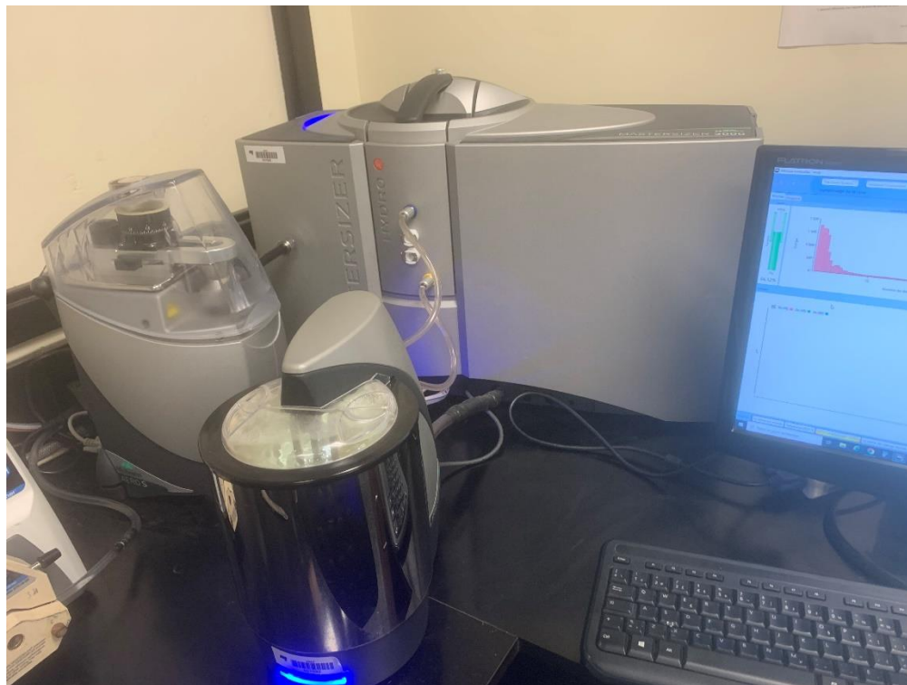
Figure 3.7 Granulomètre laser Mastersizer 3000 de Malvern Panalytical utilisé.
