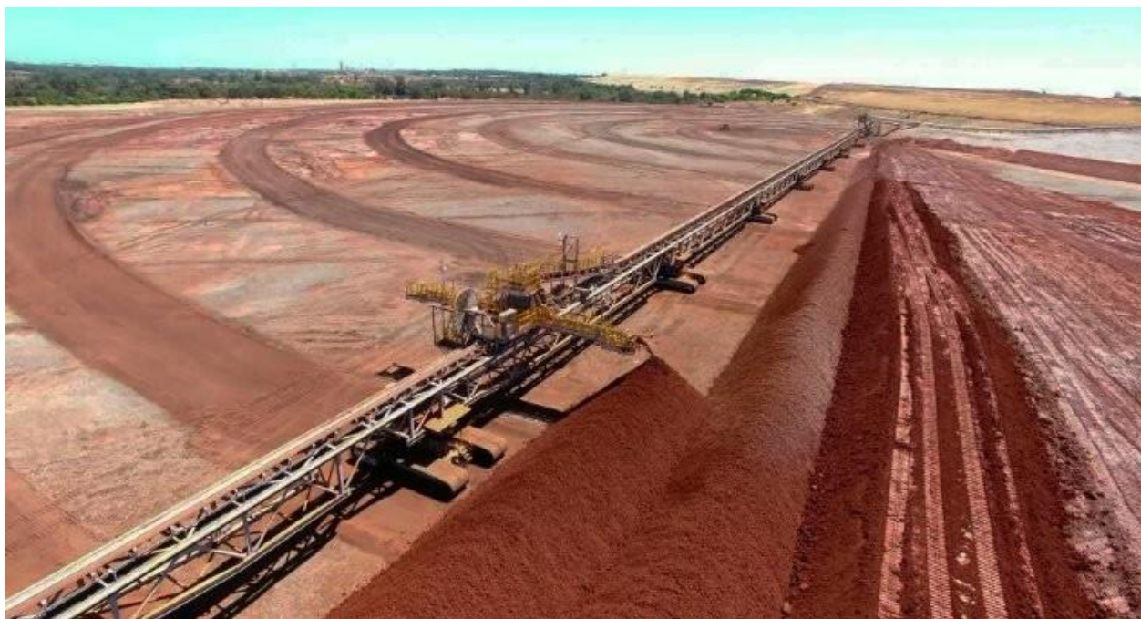
Figure 2.9 Exemple de résidus asséchés et transportés par convoyeur (Cavali, 2017).
