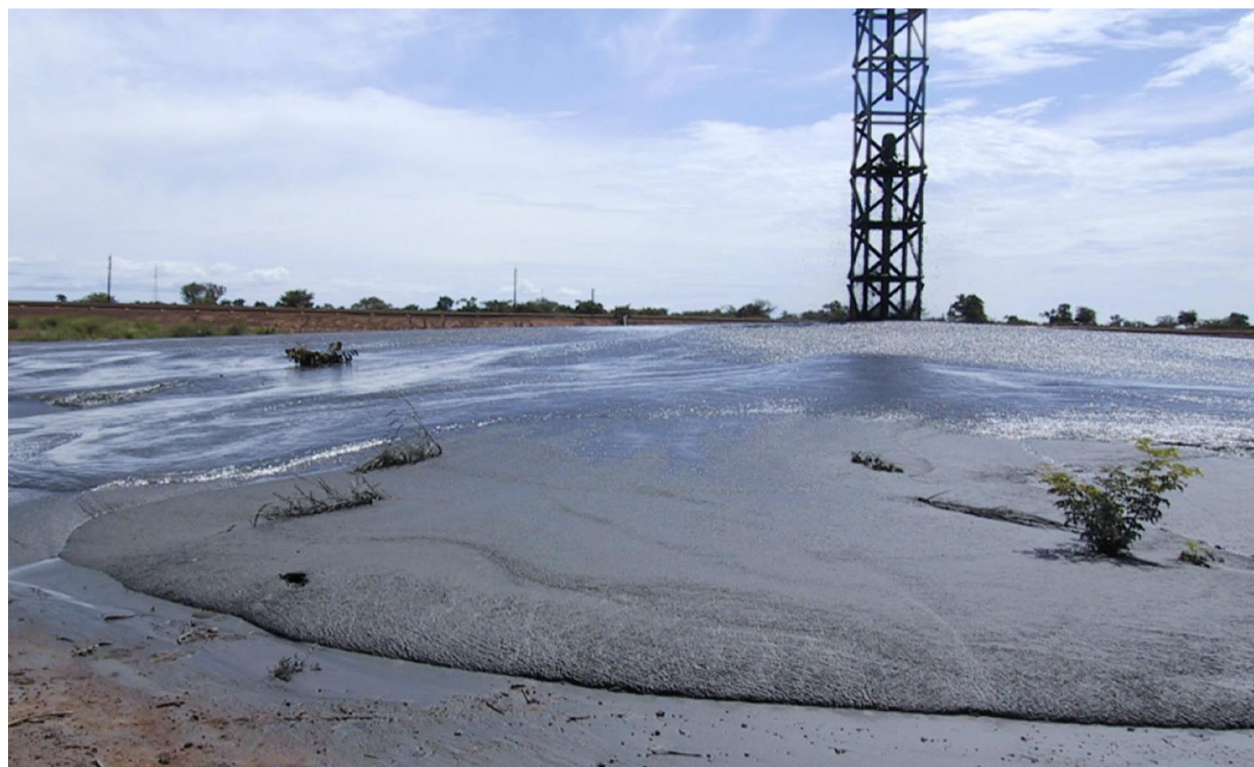
Figure 2.8 Résidus en pâte de surface du site minier de Bulyanhulu, Tanzanie (Belem, 2023).
