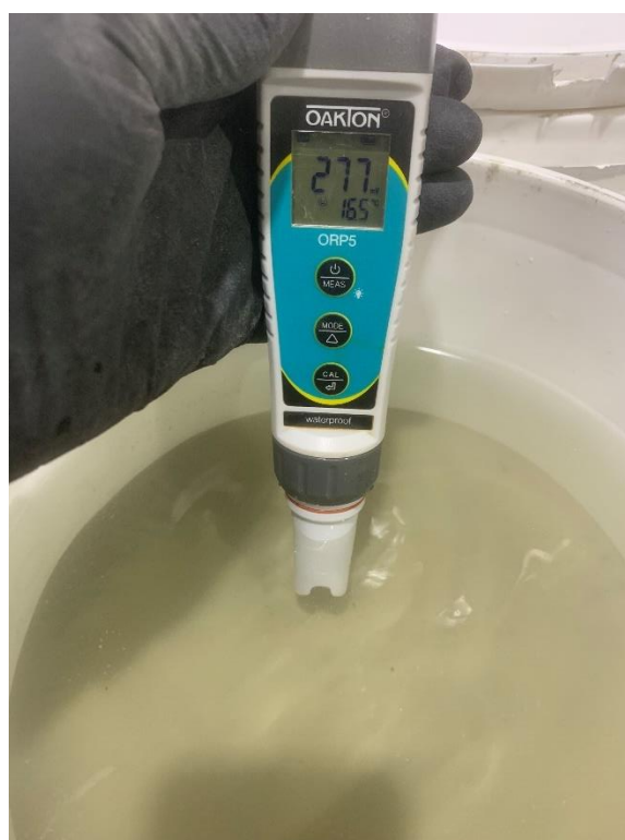
Figure 3.9 Sonde de mesure du potentiel redox.
