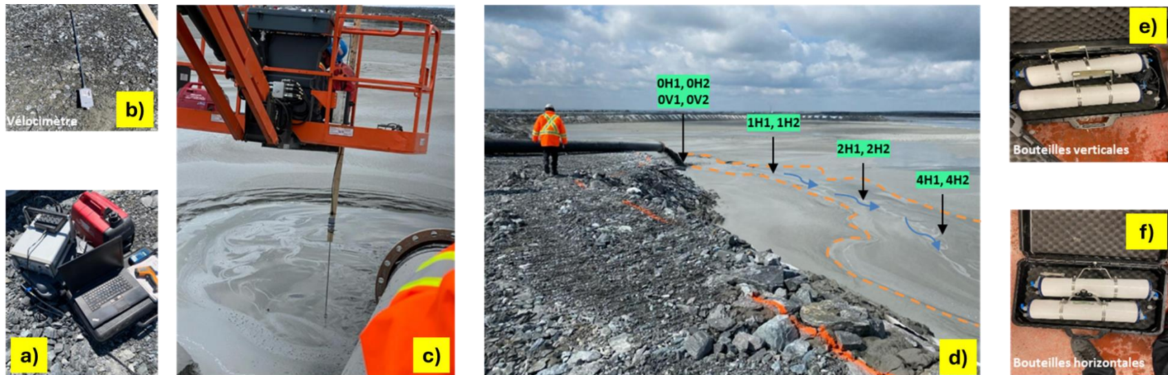
Figure 3.3 Campagne d'échantillonnage et de mesure sur le parc à résidus de la mine Canadian Malartic (MCM) : a) Ordinateur et Data logger, b) vélocimètre, c) mesures des vitesses, d) points d'échantillonnage, e) bouteille d'échantillonnage verticale, f) bouteille d'échantillonnage horizontale.
