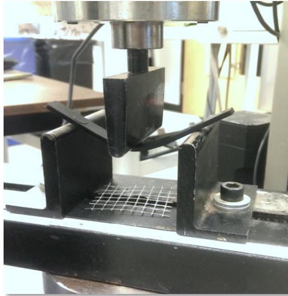
Figure 2.16 : Test de flexion à 3 points au sein du laboratoire de biomatériau de l'UQAT
