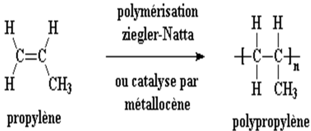
Figure 1.8 : Polymérisation du propylène (Gehring 2013)
