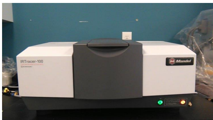
Figure 2.20 : Spectroscopie infrarouge à transformée de Fourier du laboratoire de biomatériau de l'UQAT
