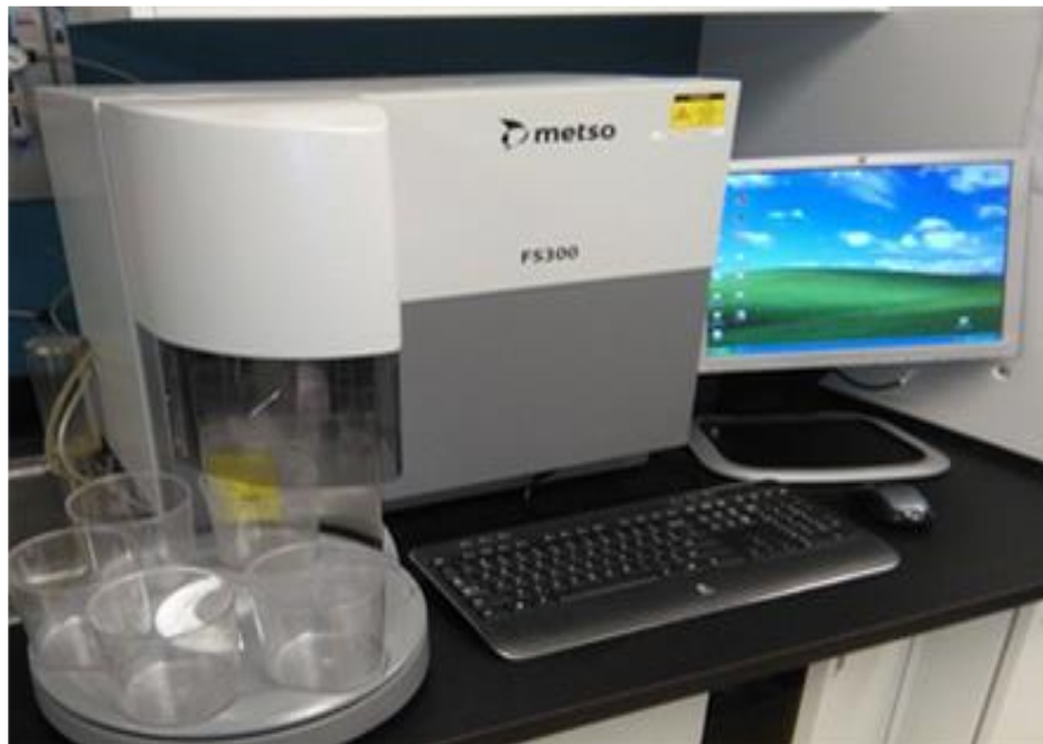
Figure 2.4 : Analyseur des fibres Metso FS300 TM du laboratoire de biomatériaux de l'UQAT
