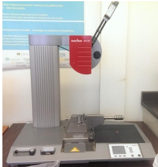
Figure 2.17 : Dispositif de test d'impact au sein du laboratoire de biomatériau de l'UQAT
