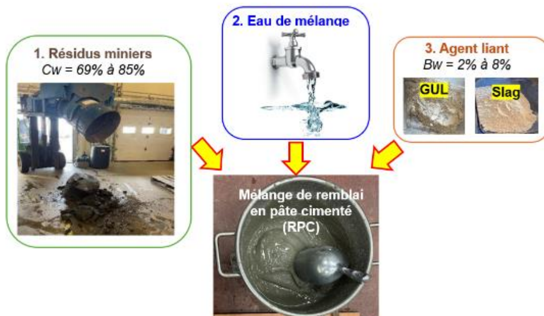
Figure 1.1 Principaux ingrédients d'un remblai en pâte cimenté
