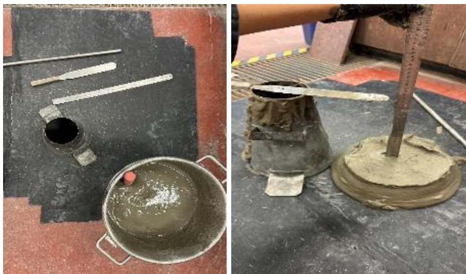
Figure 3.17 Réalisation de l'essai d'affaissement ( slump test ) avec le cône d'Abrams
