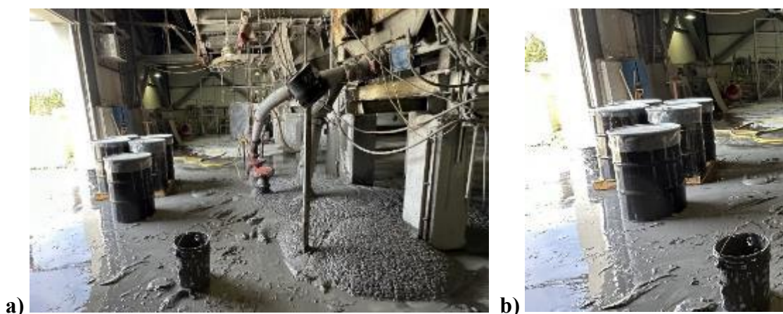
Figure 3.1 a) Usine de traitement de la mine Westwood lors de la collecte des résidus, b) barils métalliques de résidus de 200 L
