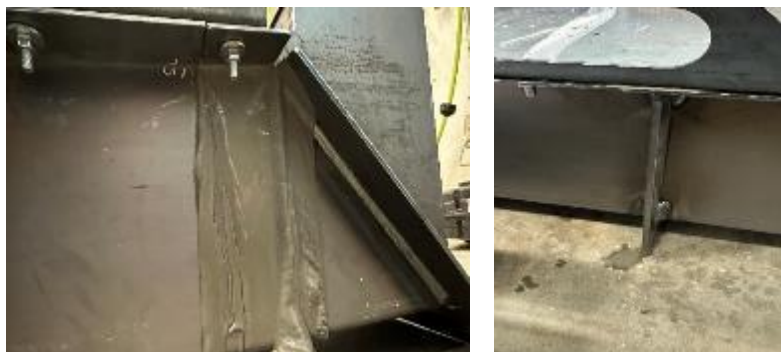
Figure 4.17 Fuites observées dans le modèle physique
