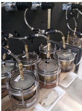
Figure 3.7 : Cellules de Tempe connectées en série à une bombonne d'azote.
