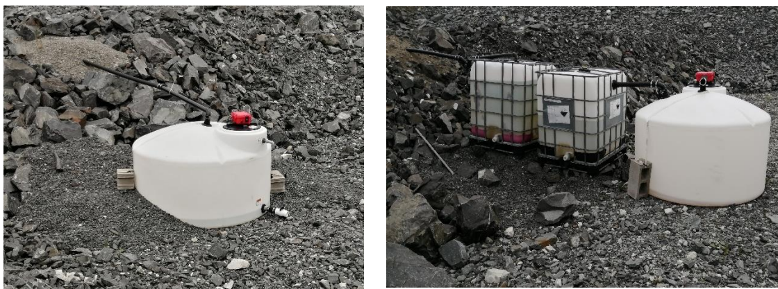
Figure 3.4 : Réservoir de collecte d'eau de percolation avec une capacité de 2000 L (à gauche) et trois réservoirs de collecte de capacité cumulative de 4000 L (à droite).
