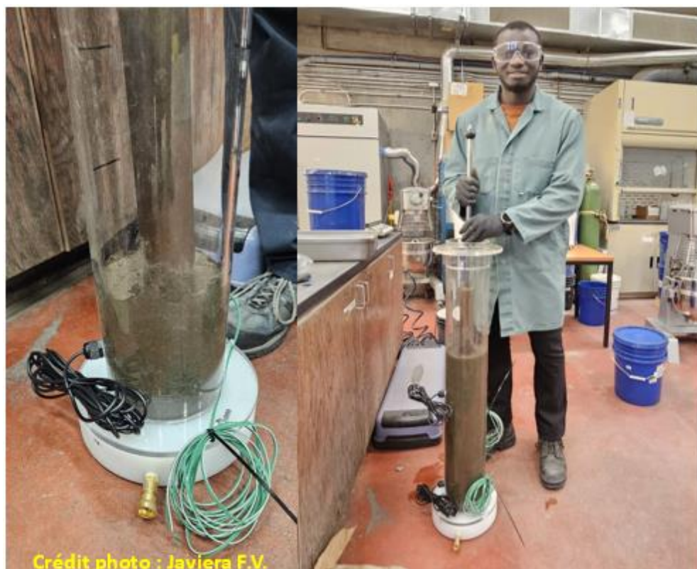
Figure 3.6 Mise en colonne des matériaux et instrumentation
