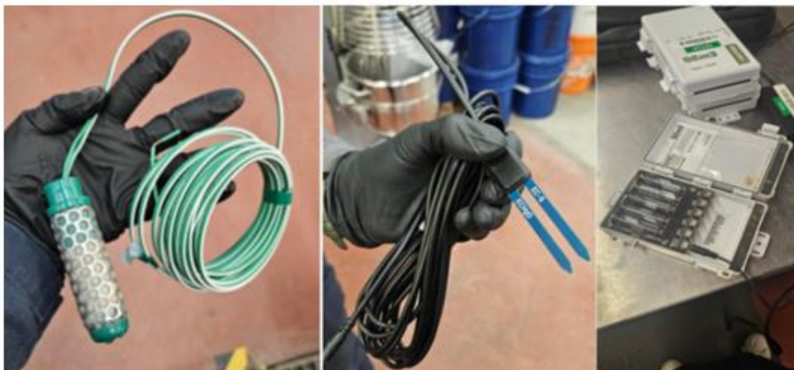
Figure 3.4 Sondes à suction et de teneur en eau + enregistreur de données (Crédit photo : Javiera Farias-Viacava, 2024)
