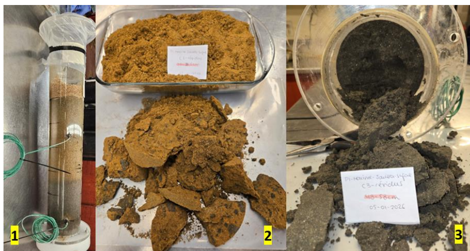
Figure 4.11 : Photos du démantèlement de la colonne C3-résidus seuls + MO (1 = front d'oxydation; 2 = précipités d'oxyhydroxydes de fer; 3 = résidus de la base avec un aspect frais).
