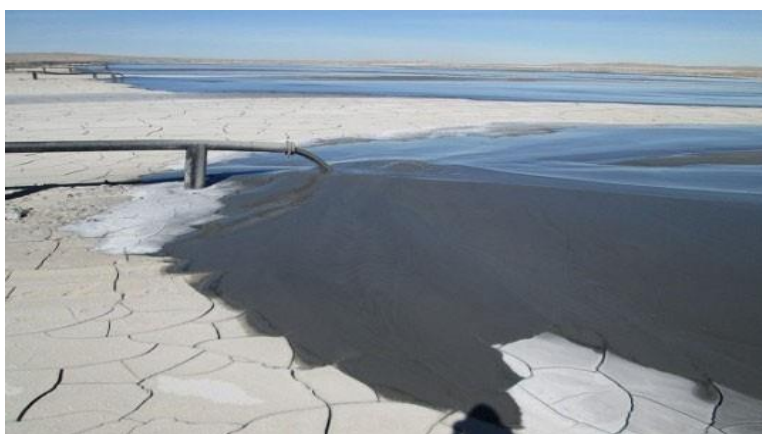
Figure 2.5 Aspect des résidus épaissis, exemple de Esperanza TSF Centinela Mine Chili (Cacciuttolo & Valenzuela, 2022).
