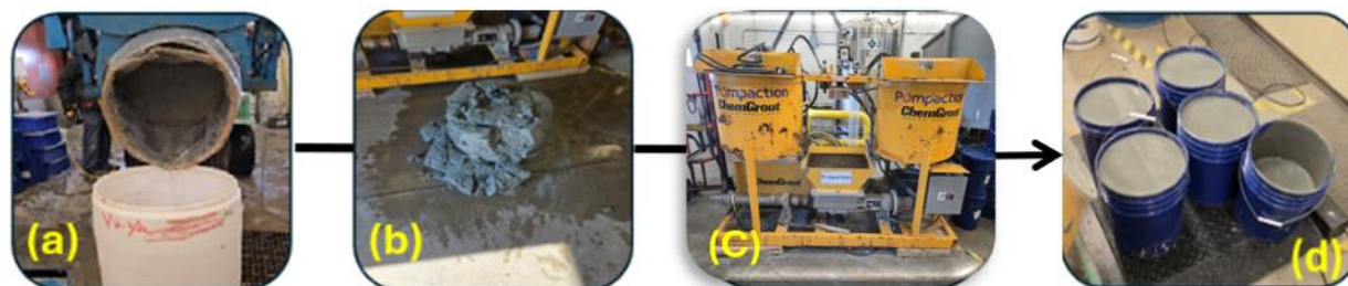
Figure 3.1 Étapes suivies pour la préparation et la caractérisation initiale des résidus: a) récupération du surnageant, b) transfert des résidus dans les chambres de la pompe-malaxeur, c) homogénéisation des résidus, d) Mise en lots des résidus pour la caractérisation initiale.
