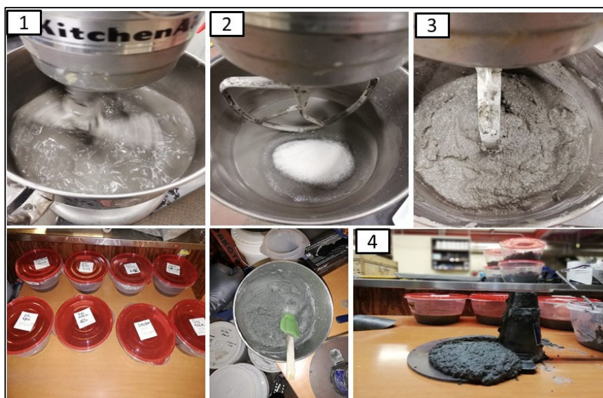
Figure C.2: Étapes expérimentales de densifications des pulpes de résidus en utilisant la méthode directe : 1. Préparation de la pulpe de résidus; 2. Ajout de l'échantillon de PSA à la pulpe et mélanger l'ensemble; 3. Obtention d'un mélange de résidus-PSA épaissi; 4. Mesure de l'affaissement du mélange résultant pour en déduire le pourcentage solide.
