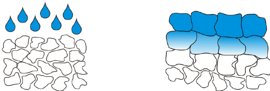
Figure 2.16: Schéma descriptif du phénomène de gel blocking (Buchholz, 2006)
