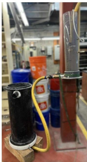
Figure 3.17 : Photographie du montage utilisé lors de l'évaluation de la conductivité hydraulique saturée d'un matériau grossier à l'aide d'une colonne de 30 cm de diamètre et de son système de maintien de la charge constante.
