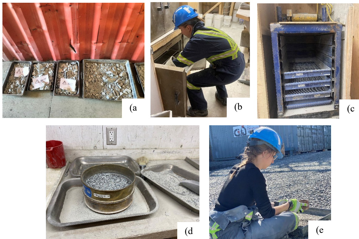
Figure 3.6 : Roches tamisées et séchées au four mises à refroidir dans le couloir (a), mise au four d'un nouveau plateau de roches tamisées (b), tamiseur mécanique avec les tamis utilisés lors de l'échantillonnage (c), tamis à main utilisés lors du tamisage (d), tamisage à l'extérieur des deux dernières lithologies avant leur séchage au four (e).
