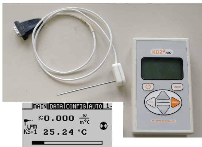
Figure 3.24: Appareil KD2Pro et de la sonde TR-1 servant à mesurer in situ la conductivité thermique du matériel. Photographie de l'écran de contrôle de l'appareil.
