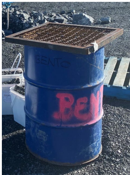
Figure 3.4 : Baril et grille 50*50mm utilisés pour le premier tamisage des différents matériaux.
