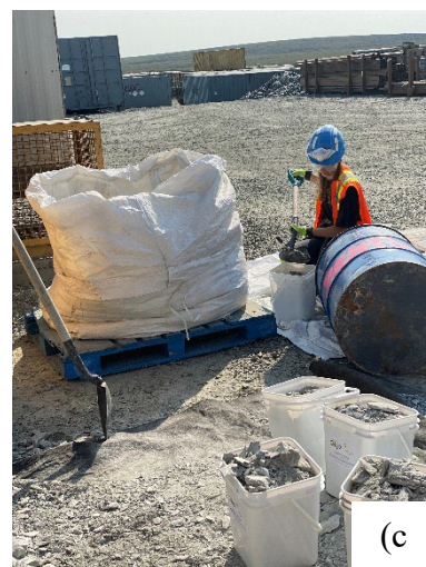
Figure 3.5 : Prélèvement du matériau dans des seaux à l'aide de pelles (a), premier tamisage du matériau à l'aide de la grille et du baril (b) et récupération du matériau tamisé (c).
