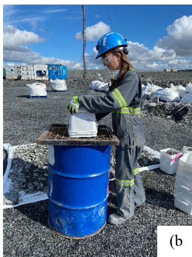
Figure 3.5 : Prélèvement du matériau dans des seaux à l'aide de pelles (a), premier tamisage du matériau à l'aide de la grille et du baril (b) et récupération du matériau tamisé (c).
