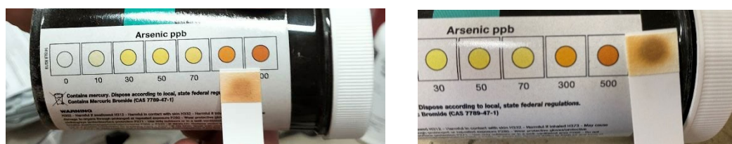
Figure 3.3: Résultats des test rapide arsenic à t+2h (a) et t+4h (b).
