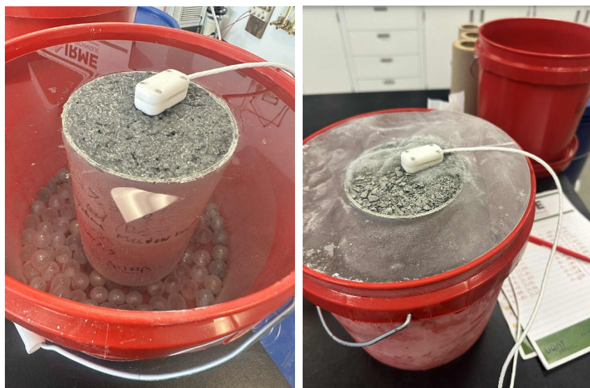
Figure 3.25 : Montage des essais de conductivité thermique à saturation complète à l'état non gelé et gelé.
