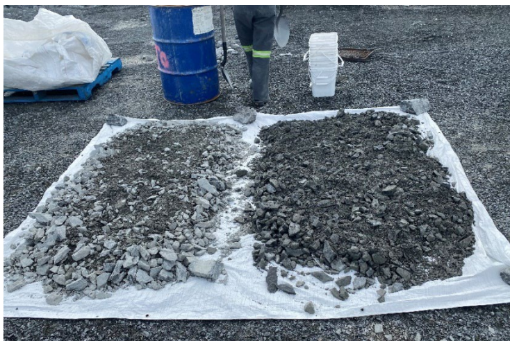
Figure 3.8 : Montage de la base de « séchage » du matériau greywacke nord. A droite, un matériel exposé une dizaine de minutes à l'air libre, à gauche un matériel fraîchement prélevé.
