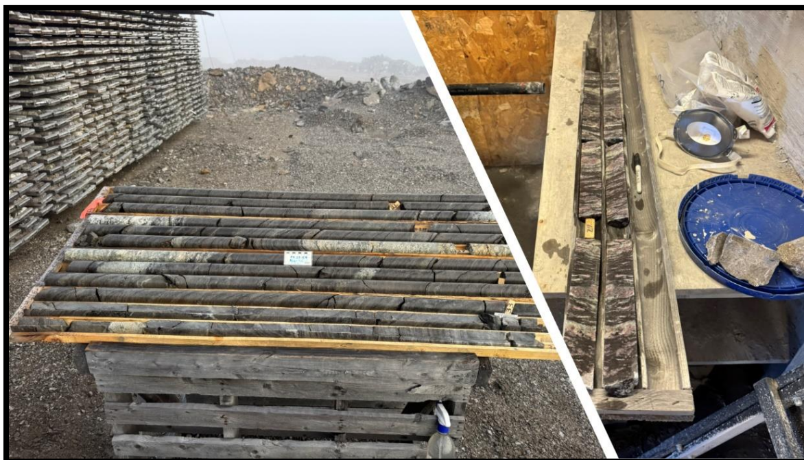
Figure 3.5 Échantillonnage de stériles à partir de carottes de forage : sélection par intervalles (0,5 m) (gauche) et sciage longitudinal des carottes pour prélèvement (droite).
