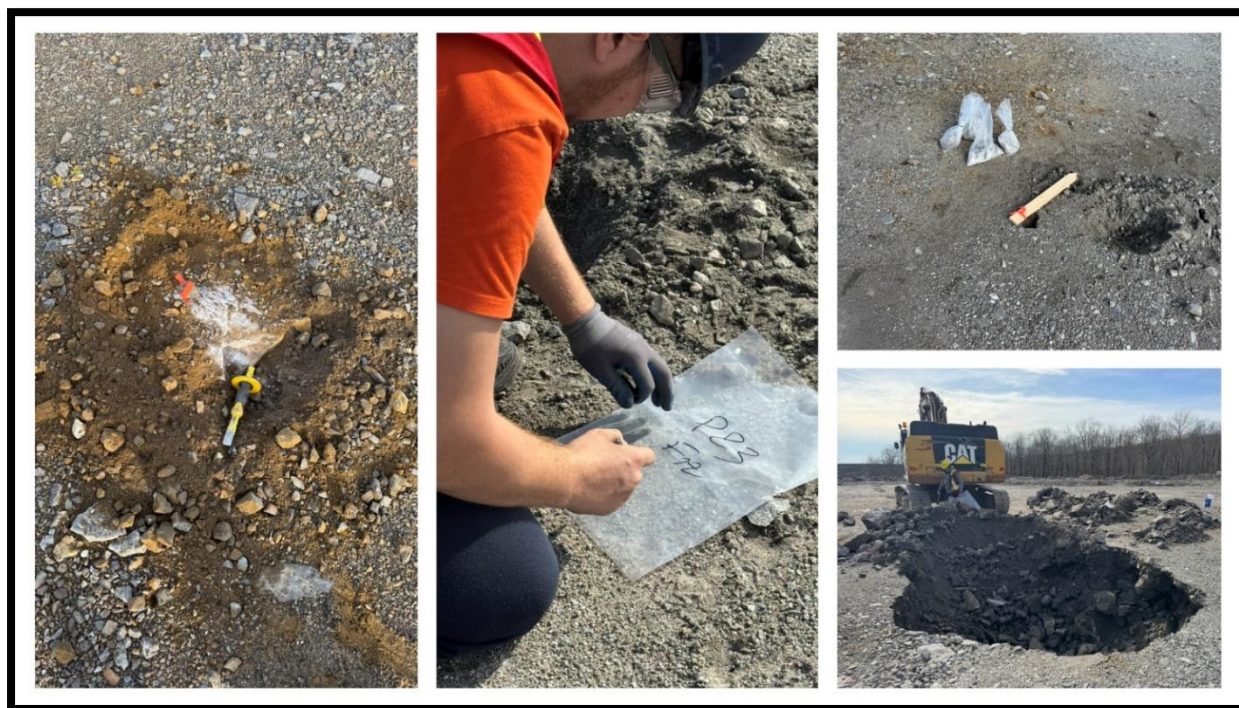
Figure 3.4 Excavation de tranchées (~3 m de profondeur) et échantillonnage en profondeur sur les haldes à stériles (variabilité verticale).
