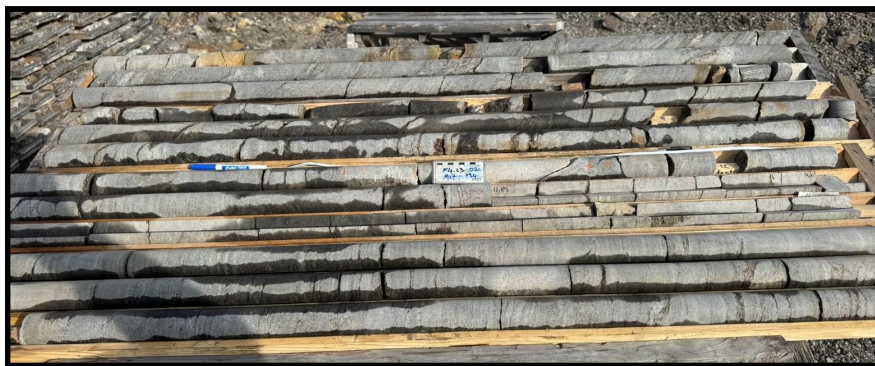
Figure 4.15 Carotte F4-23-02 associée au groupe 3, illustrant un faciès de gneiss à biotite observé dans la fosse F4
