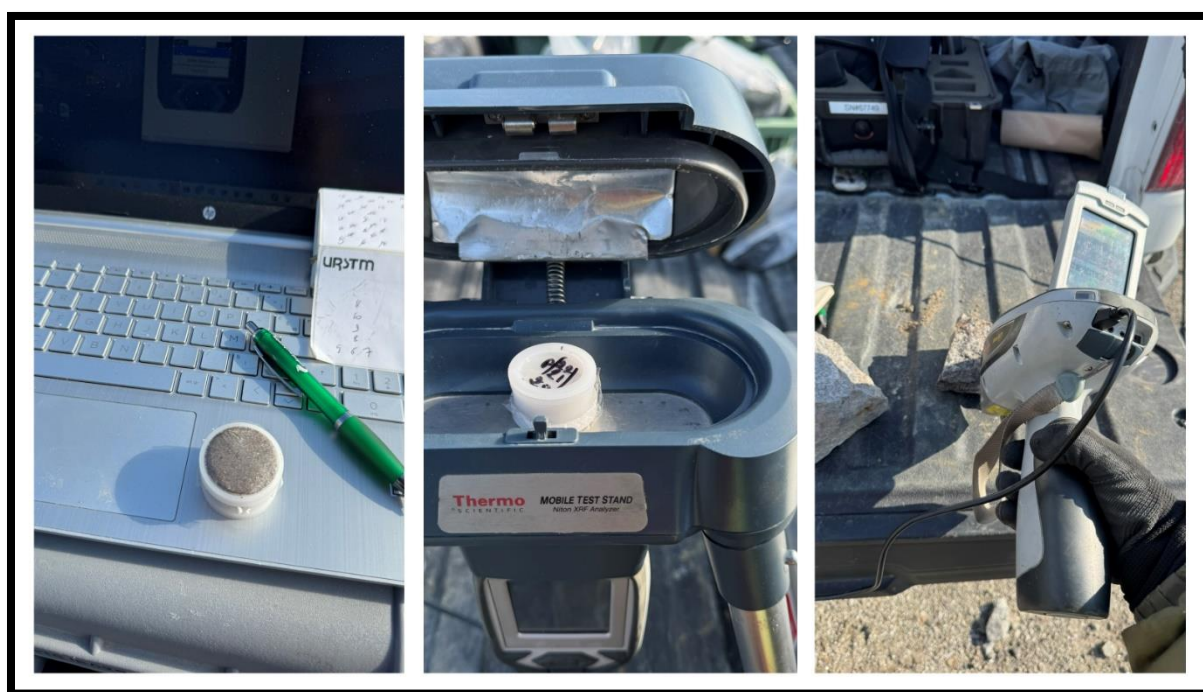
Figure 3.8 Mesures FRXp sur le terrain et préparation des échantillons (surface fraîche / nettoyage) et acquisition sur support pour la fraction fine.
