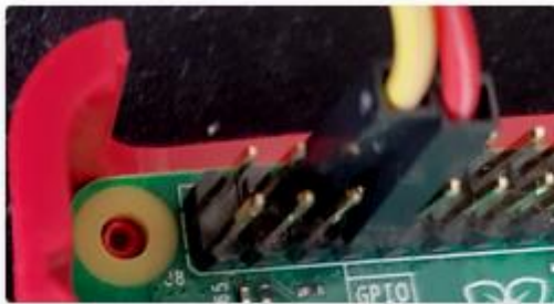
Figure 58 Configuration minimale à 2 fils pour connexion GPIO [115].
