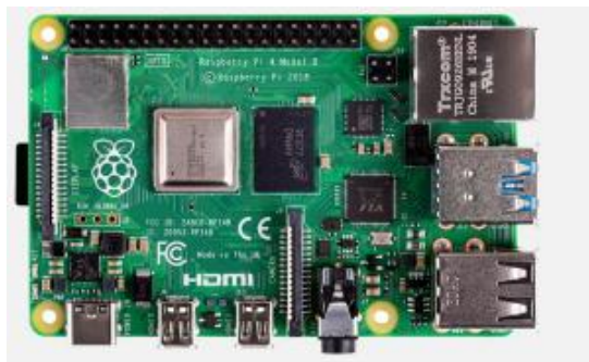
Figure 35 La carte Raspberry Pi 4 type B[103]
