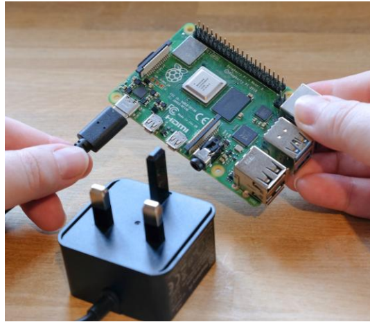
Figure 74 Alimentation de carte Raspberry pi[135].
