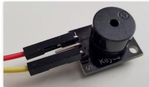
Figure 58 Configuration minimale à 2 fils pour connexion GPIO [115].
