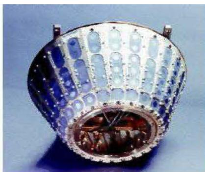
Figure 2.7. Antenne conique facettée.
