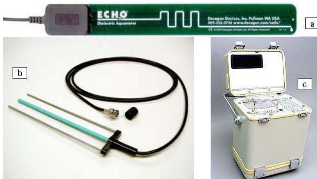
Figure A.1. Photographies (a) des sondes ECH<sub>2</sub>O, (b) des RTD « coated » et (c) du boîtier Trase d'acquisition de données pour la RTD.
