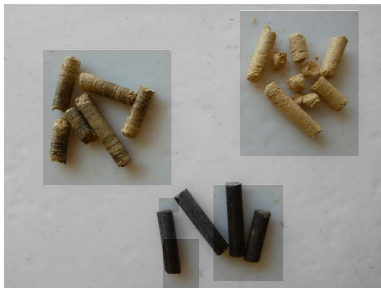
Figure 1.9 : Granules ayant différents états de surface - de gauche à droite, granules avec les couches visibles, granules de bois torréfiées et granules claires friables par manque d'eau
