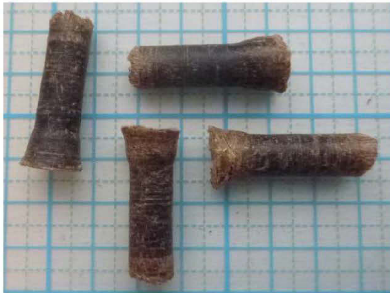
Figure A.4 : granules extraites par l'entrée des canaux de la matrice
