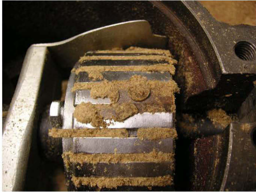
Figure A.3 : aperçu de la couche fusionnée et collée au rouleau
