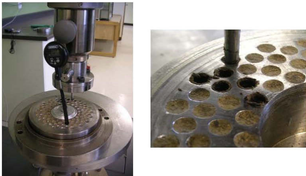
Figure 3.4 : Mesure de la force de dégagement de la granule prise dans le canal, filière chaude, dans les 10 min suivant la fin de l'essai de granulation
