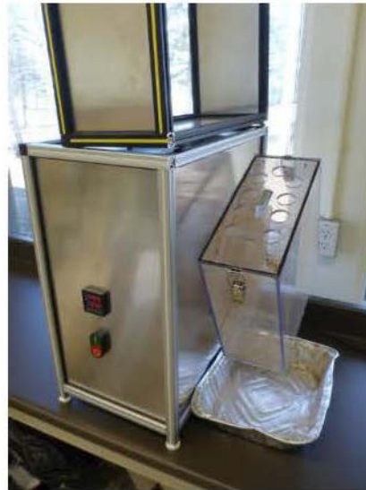
Figure 3.5 : Durabilimètre avec caisson ISO construit pour notre usage avec commande automatique par compte-tour et affichage du compte à rebours
