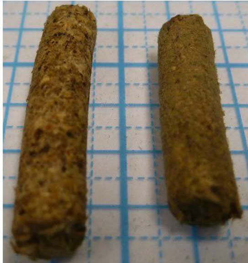
Figure 4.10 : Comparaison entre une surface brossée pour retirer les moisissures de la granule et une surface moisie laissée intacte (à droite)
