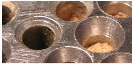
Figure 2.10 : Modification de l'angle de chanfrein des canaux après les essais préliminaires
