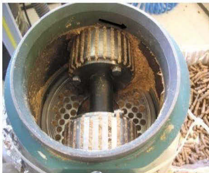
Figure 2.7 : Aperçu du problème d'accumulation de sciure entravant la rotation du rouleau
