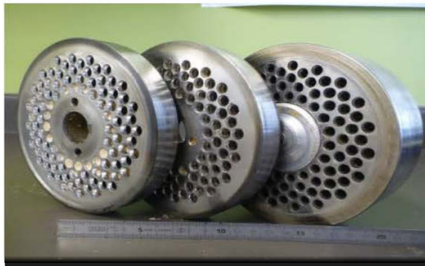
Figure 2.8 : Vue des trois filières utilisées: à gauche, la filière standard fournie par le constructeur, au milieu, une filière standard avec une entrée élargie par nos soins, à droite, filière épaisse spécialement usinée et utilisée uniquement pour nos travaux.
