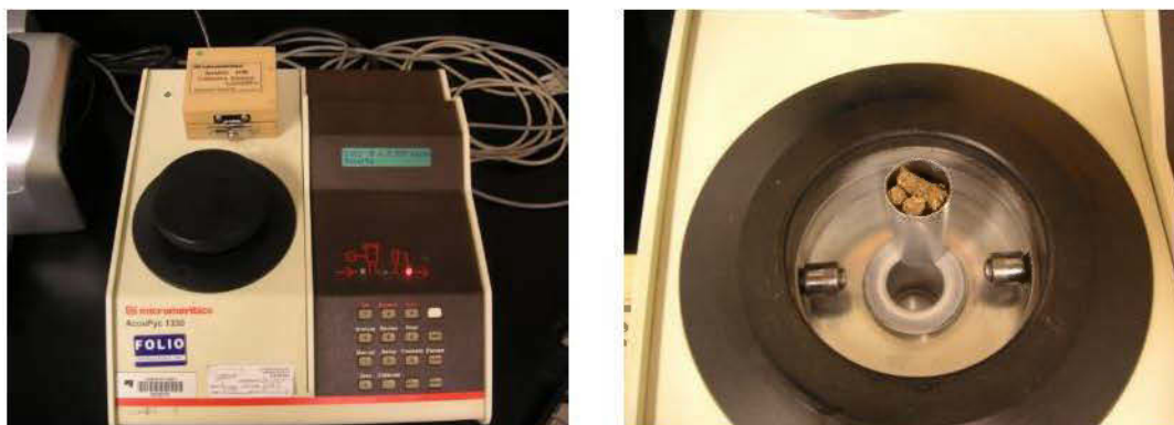
Figure 3.10 : Aperçu du pycnomètre et de la chambre de mesure avec des granules
