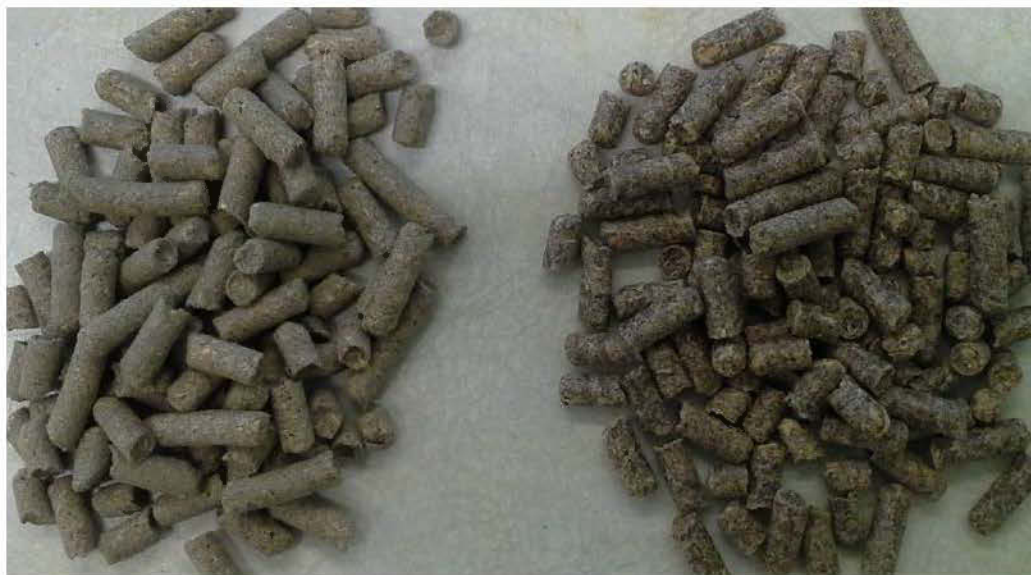
Figure 4.9 : Observation de moisissures sur des granules très humides (>20% d'humidité), aspect entre un tas de granules moisies (à gauche) et un tas de granules sains
