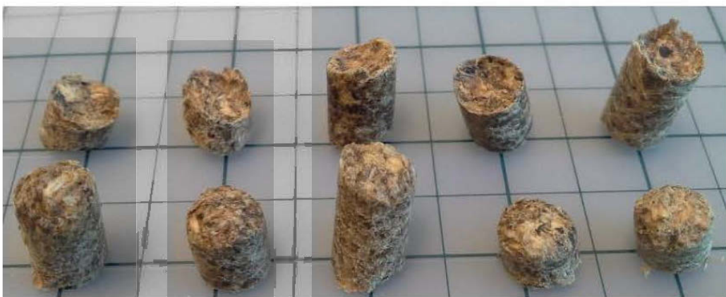
Figure 4.18 : Aperçu de la forme prise généralement aux extrémités des granules la rangée inférieure est la forme de l'extrémité visible des granules sortant de la filière.
