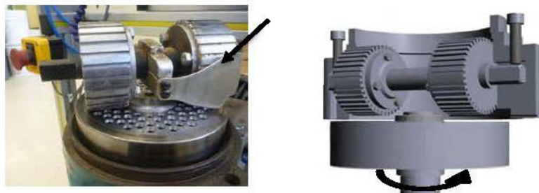
Figure 2.6 : Aperçu de l'équipage mobile de la chambre de granulation et des déflecteurs
