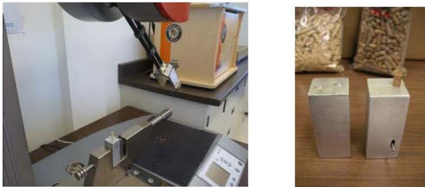
Figure 3.6 : Banc d'essai de résistance au choc Izod et porte-échantillons pour granule
