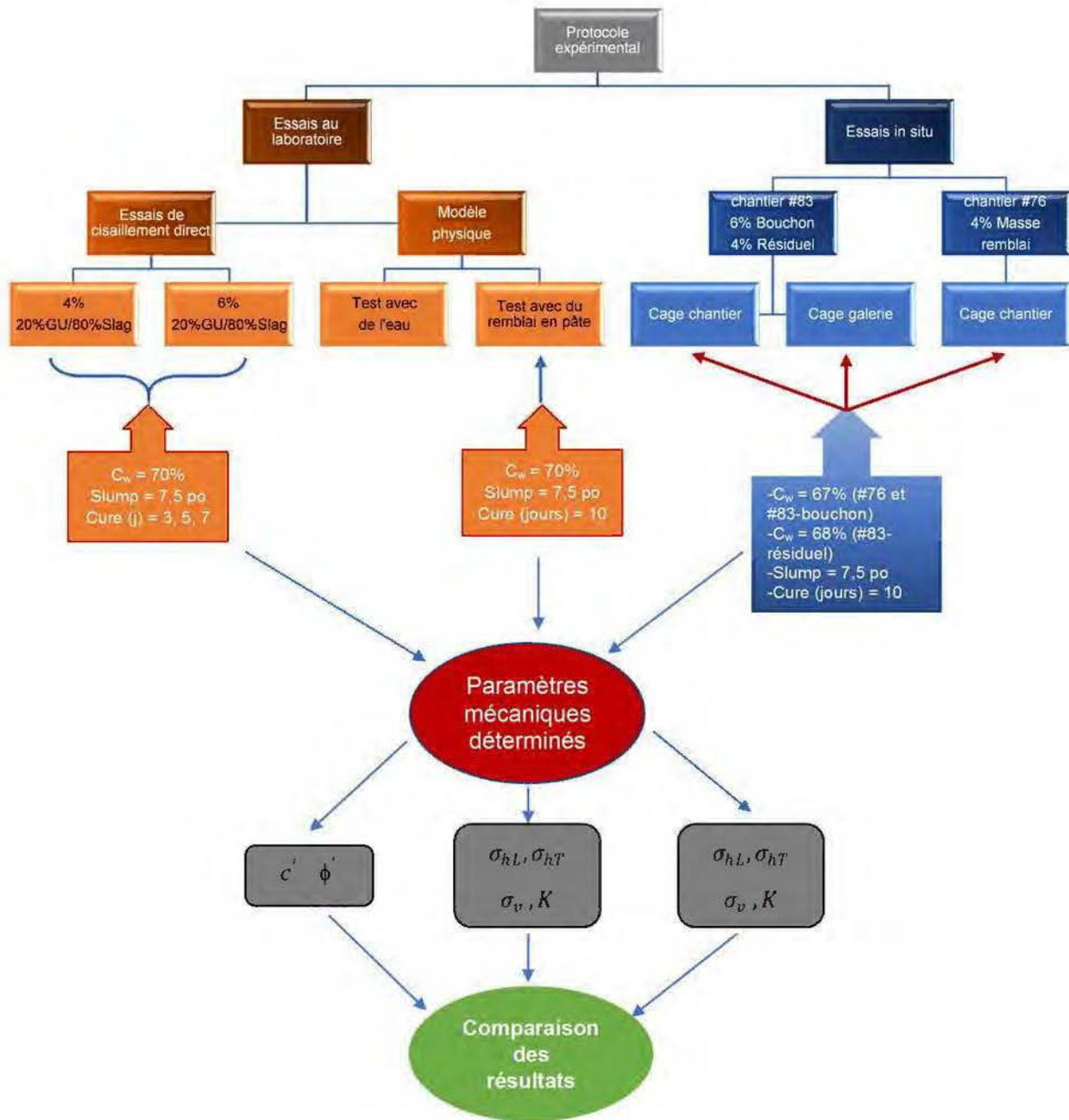
Figure 1–4 Diagramme schématique de la méthodologie de l'étude
