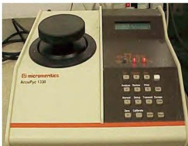
Figure 3–3 Pycnomètre à hélium AccuPyc 1330 de Micromeritics®
