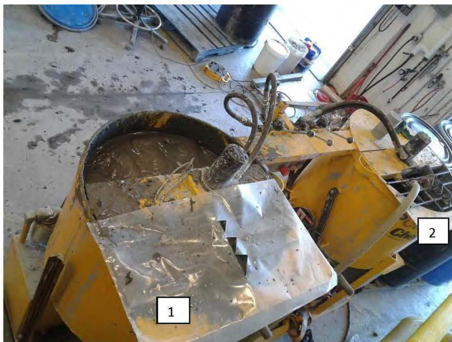
Figure 3-25 Préparation du remblai dans le mélangeur-pompe
