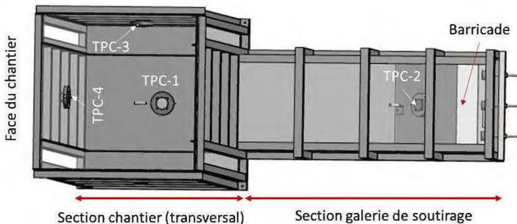
Figure 3-9 Vue du dessus du modèle physique instrumenté
