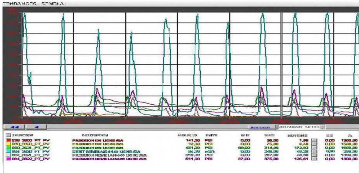
Figure 2–28 Exemple typique d'évolution des pressions à différents niveaux d'une coulée instable observée sur le logiciel iFix (logiciel de suivi des pressions sous terre) (mine Westwood)
