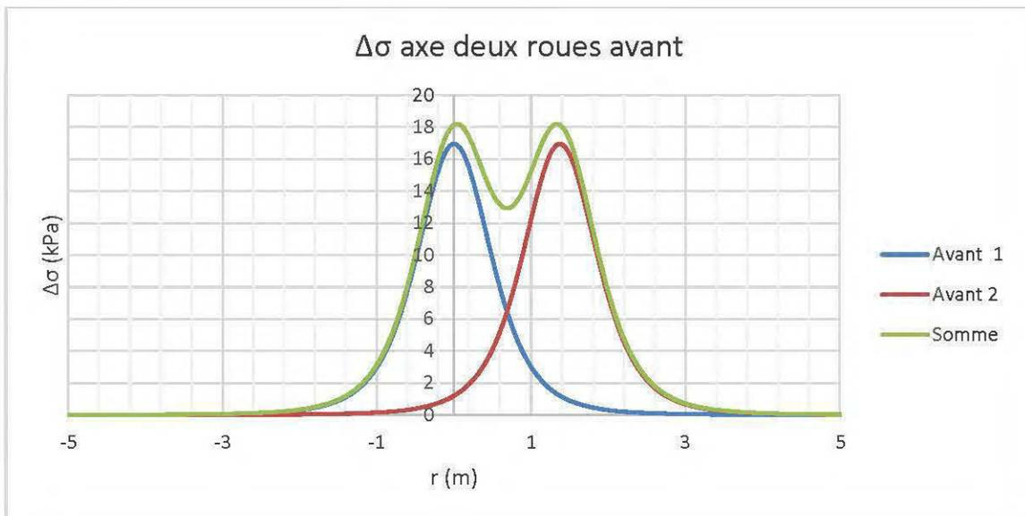
Figure 2–21 Contraintes induites selon le modèle de Boussinesq à 1m de profondeur, entre les deux roues avant d'une chargeuse-navette,  $r$  étant la distance radiale entre une des deux roues du front et le point de calcul
