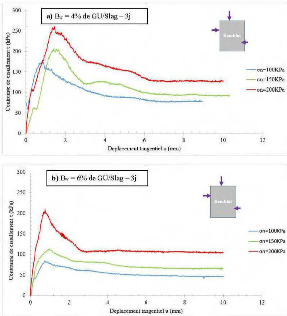
Figure 4–1 Courbes de contrainte-déplacement tangentiel des blocs de remblai curés à 3 jours avec a) 4% de liant, b) 6% de liant.
