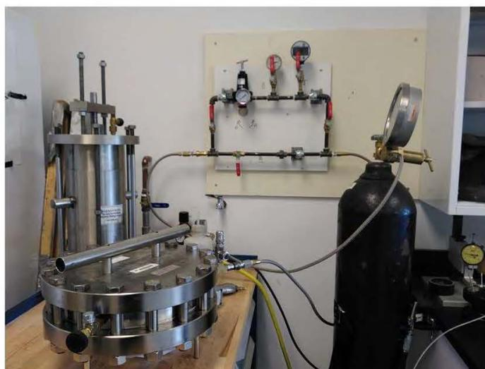
Figure 3-6 : Montage utilisé pour les essais à l'extracteur à pression
