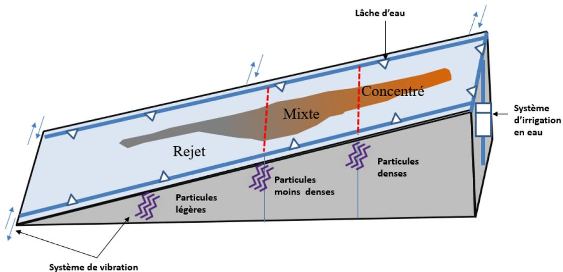
Figure 3.2 Schéma de la table de Mozley pour concentrer les sulfures denses
